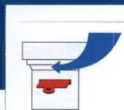
Следить за исправностью дымоходов и вентиляционных каналов - проверять тягу до и после включения газового оборудования с отводом продуктов сгорания в дымоход, а также периодически во время его работы;
